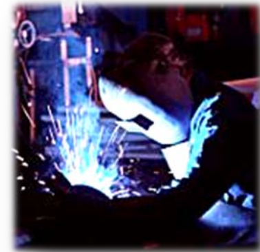
Le technicien porte un masque spécial pour faire de la soudure à l'arc
